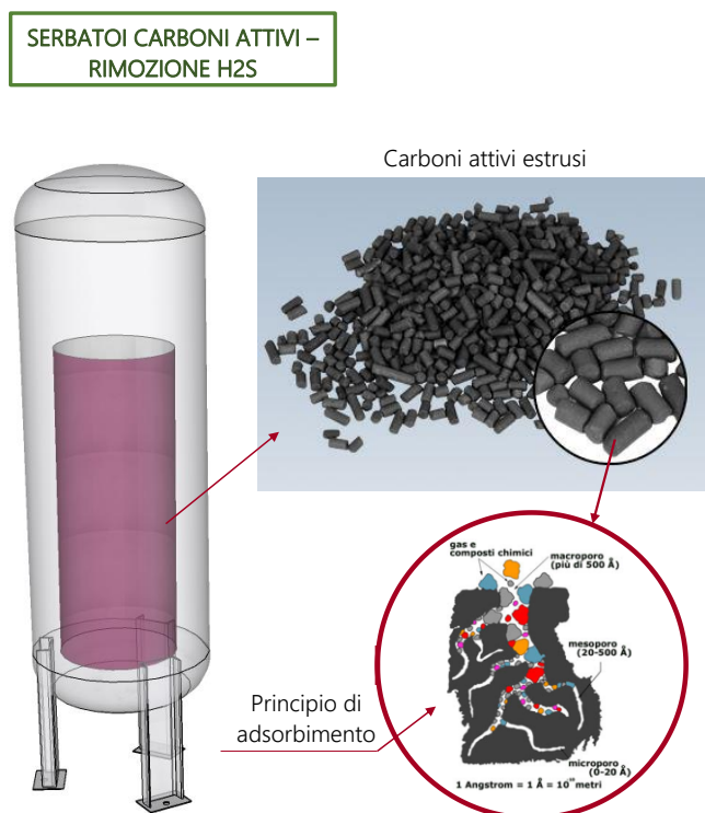
Figura 17: Layout funzionamento carboni attivi
